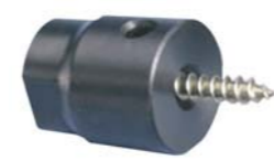
MD115 Ein Minischraubenfutter der Spitzenklasse. Die Schraube lässt sich jederzeit austauschen und wird durch eine Madenschraube sicher gehalten.
