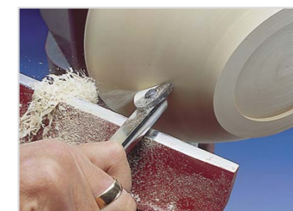
Gebrauch der geraden Schneide an der Außenseite
