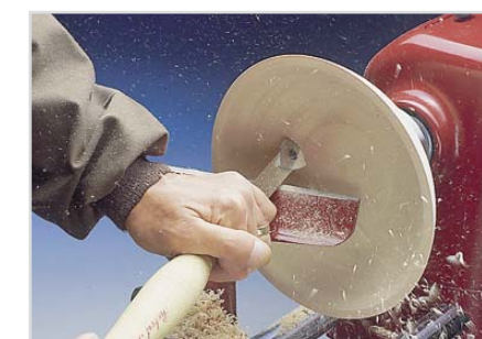
Einsatz der runden Schneide an der Innenseite
