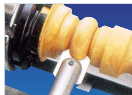
RS 235 C und RS 238 C erlauben das Profilieren. Ideal für Dosen mit Deckeln.
