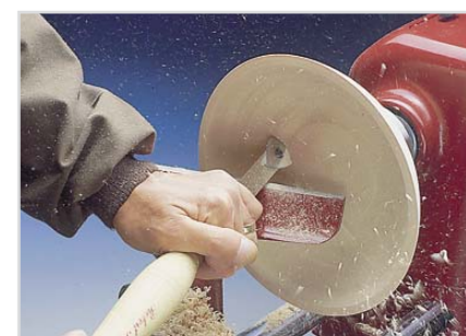
Einsatz der runden Schneide an der Innenseite
