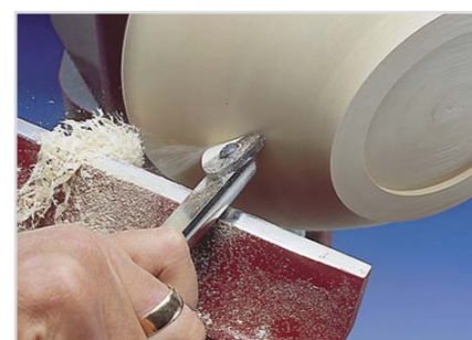
Gebrauch der geraden Schneide an der Außenseite
